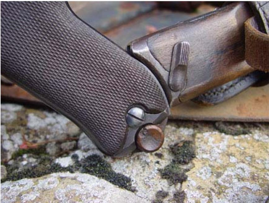
Il sistema di aggancio del calciolo, con la sua leva di fermo. Una volta inserito nella rotaia, esso viene messo in posizione mediante una rotazione di circa 15 gradi e quindi bloccato ruotando la leva, il cui corpo cilindrico si incastra nel corrispondente scasso sull'innesto
