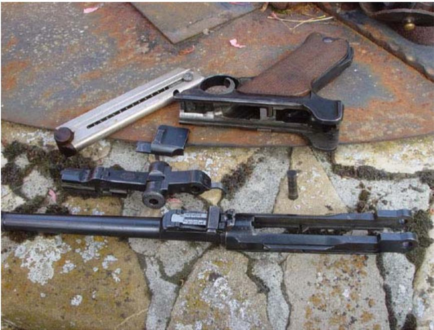
Smontaggio da campagna della LP.08. Le operazioni di disassemblaggio sono identiche a quelle per la Parabellum P.08
