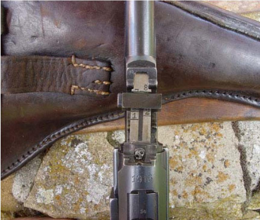
La foglietta regolabile della Lange Pistole 08 del 1916. Si nota la testa della vite micrometrica di regolazione
