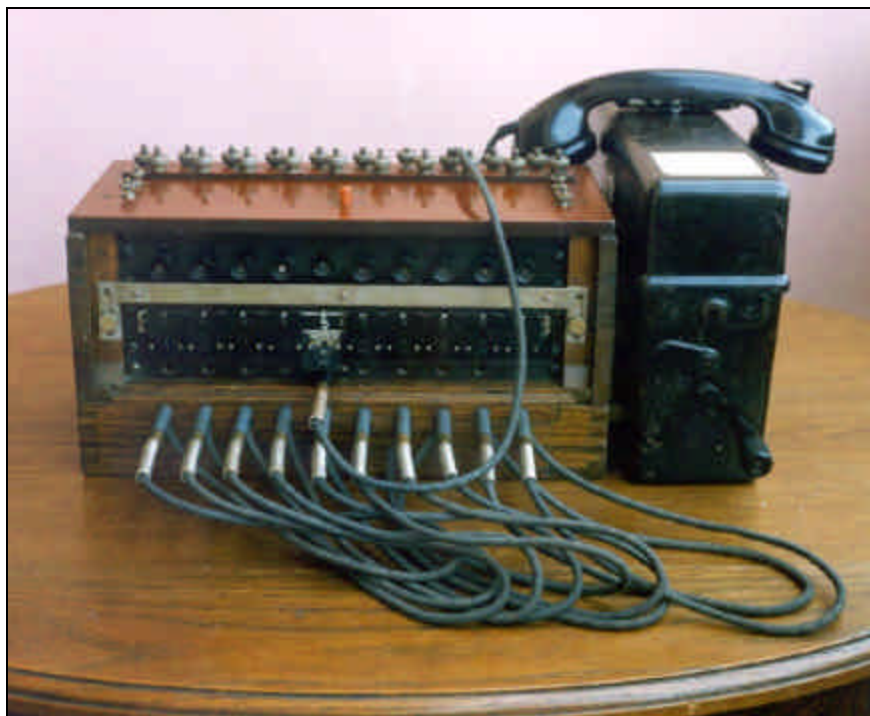
Centralino a 10 linee collegato con FF 33
